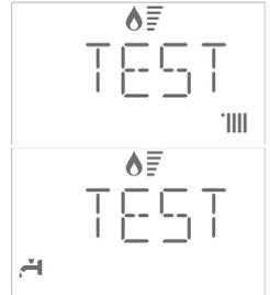
Attendre 1 minute pour que la chaudière se stabilise avant de réaliser les analyses de combustion. Relever la valeur de CO<sub>2</sub> (%) et la comparer aux valeurs contenues dans le Tableau A ci-dessous.
